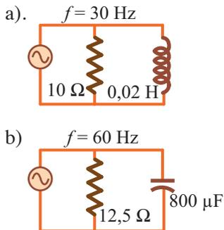
11. Déterminer l'impédance des circuits suivants.
