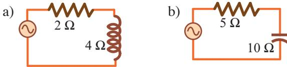
10. Déterminer le circuit série équivalent au circuit donné à la fréquence indiquée.
