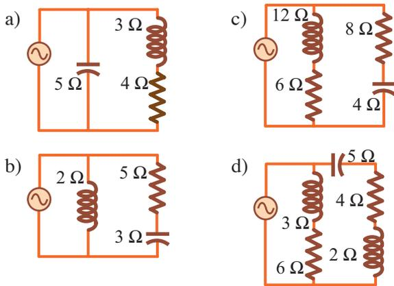
12. Déterminer le circuit série équivalent au circuit illustré dans les cas suivants.
