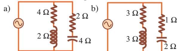
8. Déterminer le circuit série équivalent au circuit illustré dans les quatre cas suivants.
