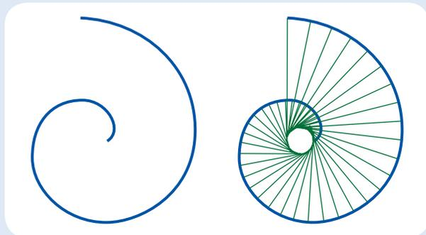
On peut aussi interpréter la figure d'une autre façon. Si on déroule une corde enroulée autour d'un cercle en la maintenant bien tendue, on obtient la développante du cercle.
