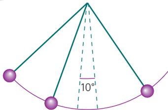
Dès que l'amplitude dépasse 5 degrés par rapport au point le plus bas, le pendule n'est plus parfaitement synchrone.
