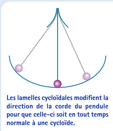
**Les lamelles cycloïdales modifient la direction de la corde du pendule pour que celle-ci soit en tout temps normale à une cycloïde.**
