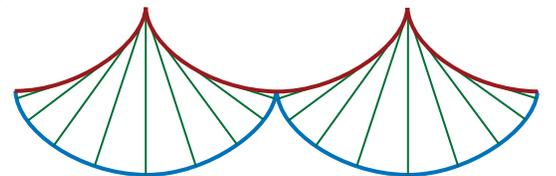
Pour que la masse suive une trajectoire cycloïdale, il faut contraindre la corde du pendule à occuper les positions successives de la normale à la cycloïde.
