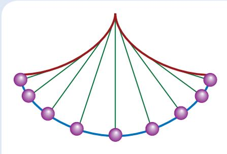
En pratique, il n'est pas nécessaire dans un pendule d'avoir une amplitude aussi imprtante que dans la figure précédente. Il suffit d'ajouter deux lamelles qui auront pour effet de modifier la direction de la corde en temps réel de sorte que la masse ait une trajectoire cycloïdale.
